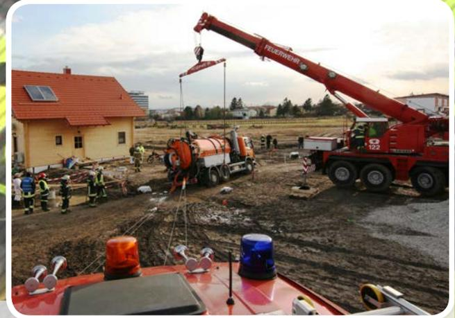
Am 23. Jänner wurde die FF Guntramsdorf zur Unterstützung nach Gumpolskirchen alarmiert. Ein Kanalspül- und Saugwagen war im nicht befestigten Erdreich eingesunken und drohte umzustürzen. Das Kommunalfahrzeug wurde mittels 2 Seilwinden gesichert und anschließend vom Kranfahrzeug der FF Mödling wieder auf festen Untergrund gehoben. Es standen 3 Feuerwehren mit 9 Fahrzeugen und 27 Mitgliedern im Einsatz.
