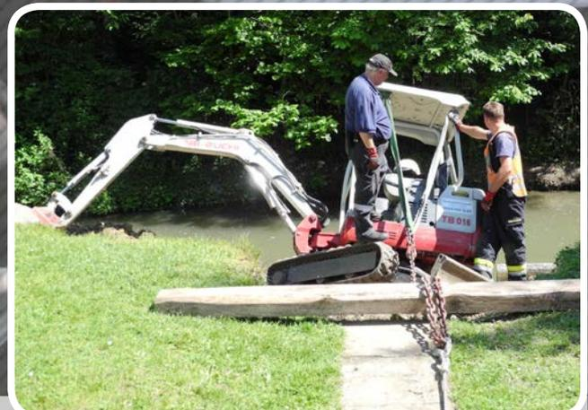
Zu einer Baggerbergung wurden wir am 9. Mai in die Keltengasse alarmiert. Da das Erdreich unter dem Bagger wegrutschte drohte dieser in den Wiener Neustädter Kanal zu stürzen. Mittels Greifzug wurde der Bagger gesichert und anschließend wieder, unter Mithilfe des Greifzuges, auf sicheres Gelände gefahren.
