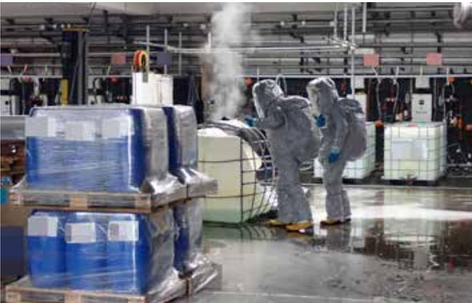
Da die Abwässer des ganzen Firmengeländes über eine Neutralisationsanlage führen und keine kontaminierten Abwässer das Betriebsgelände verlassen können, wurde in Absprache mit Chemikern des Betriebes entschieden, den Schadstoff mit viel Wasser zu verdünnen.
